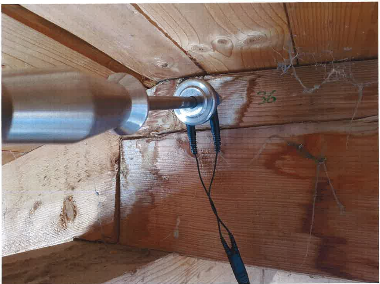
Abbildung 5: Holzfeuchtemessung im Bereich deutlicher Wasserablaufspuren unterhalb der Dachschalung.
