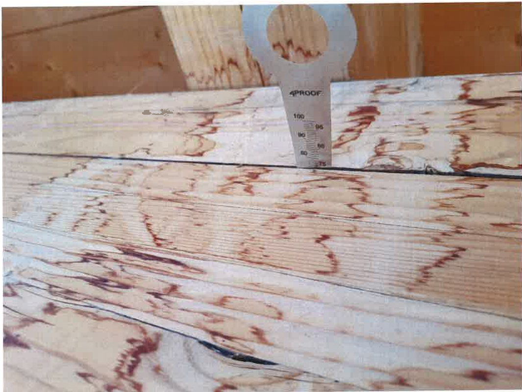
Abbildung 10: Risstiefe bei Prüfstelle Nr.47 (Balken in Abbildung 9)
